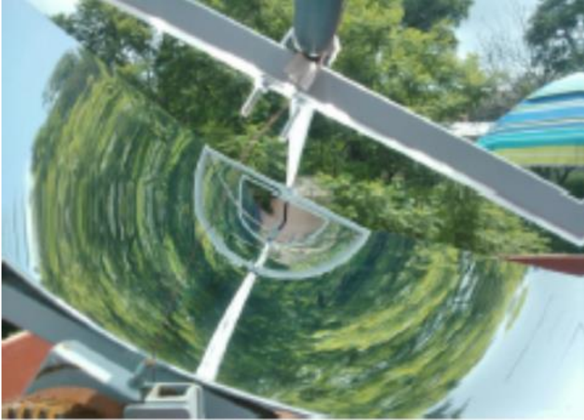
Figura 5. Fotografía del tubo receptor del CCP
