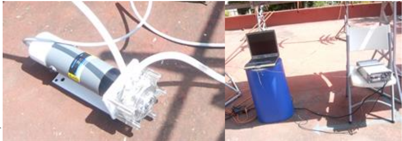
Figura 7. Bomba peristáltica y SAD.
